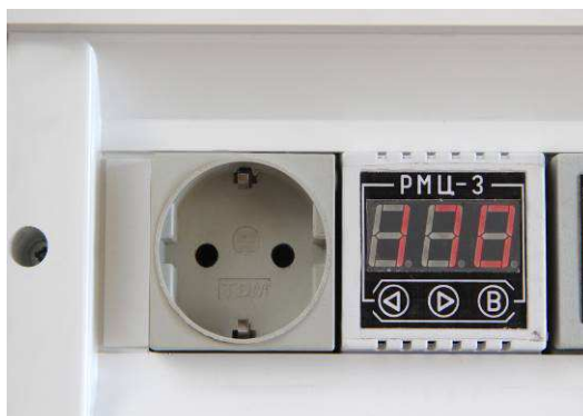
Фото 3 Модуль РМЦ и розетка подключения ТЭНов
