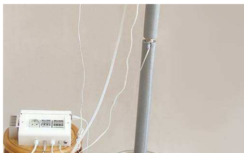
Фото 30 Термометр в средней части колонны
